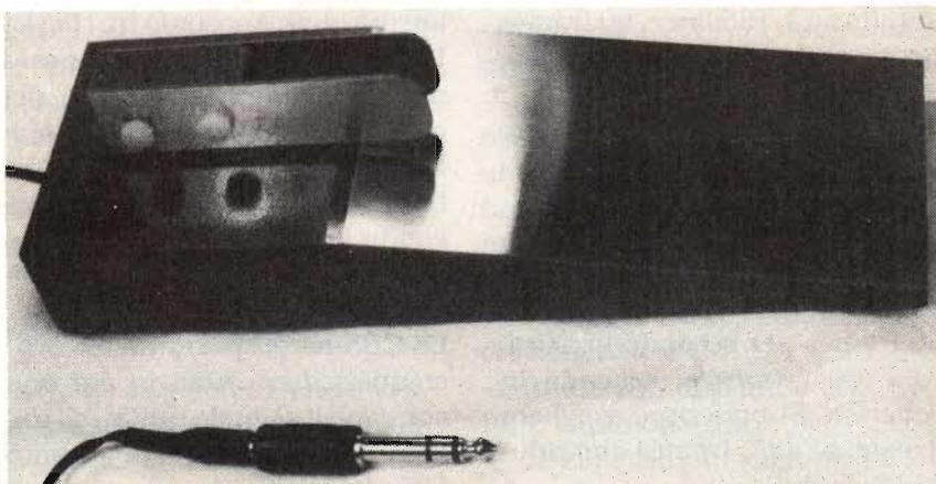
*Foto A. Il tasto elettronico. La superficie obliqua è costituita dalla basetta ramata di massa del circuito.*
