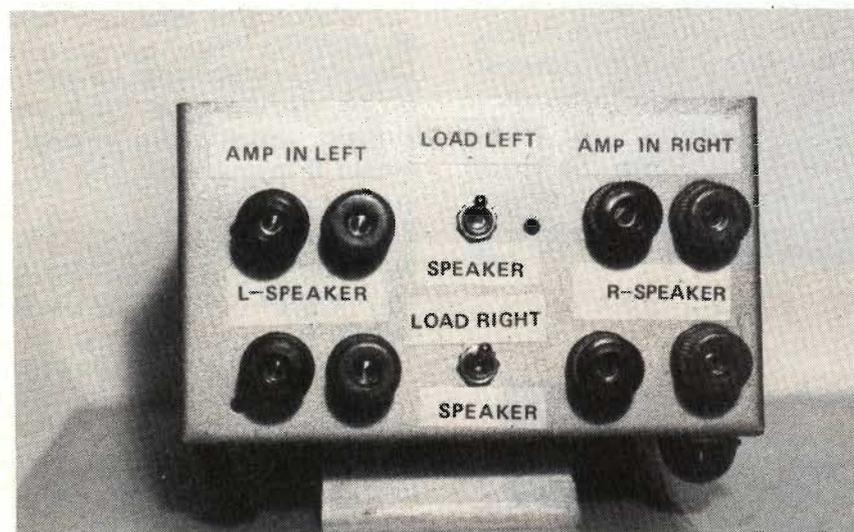
**Figura 3.** Le boccole per il collegamento di strumenti per effettuare test, si montano sul pannello posteriore (A), mentre quelle per il collegamento all'amplificatore e agli altoparlanti, si montano sul pannello anteriore (B).
